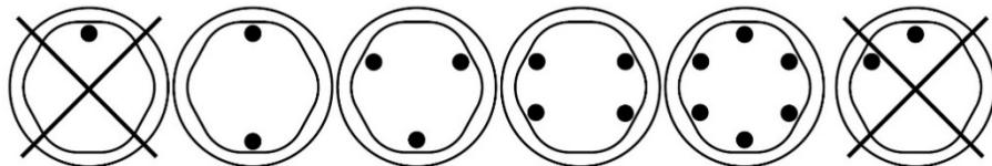
*Nádoby lze na obvod rotoru umísťovat v kterékoli ze znázorněných konfigurací zatížení rotoru.*
