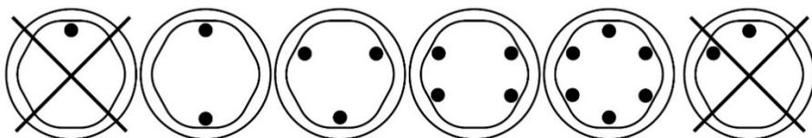
*Las cubetas pueden colocarse alrededor del rotor en cualquiera de las configuraciones de carga que se indican. Cada cubeta debe cargarse con tubos de forma simétrica, tal como se indica arriba.*
