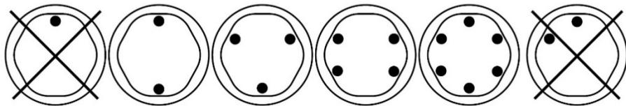
*Kubełki można umieszczać wokół rotora w dowolnej z przedstawionych konfiguracji ładowania rotora.*
