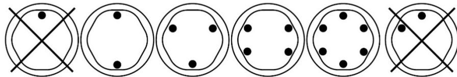
*Podem ser colocados recipientes à volta do rotor em qualquer uma das configurações apresentadas.*
