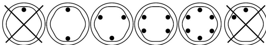
*Kovalar, gösterilen rotor yükleme konfigürasyonlarından herhangi birinde rotorun etrafına yerleştirilebilir.
