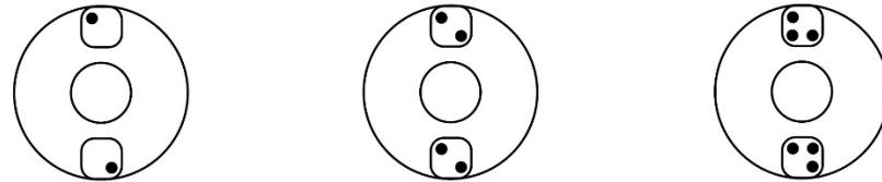
*Los vasos pueden ser colocados alrededor del rotor en cualquiera de las configuraciones de carga de rotor mostradas. Cada vaso debe estar cargado con tubos de manera simétrica como se muestra en la figura anterior.*
