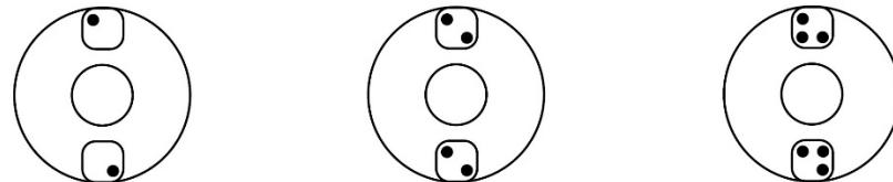
*Les godets peuvent être placés autour du rotor dans l'une des configurations de chargement de rotor illustrées. Chaque godet doit être chargé de façon symétrique avec les tubes comme ci-dessus.*
