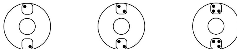
*Die Schaufeln können um den Rotor herum in jeder der dargestellten Rotorbelastungskonfigurationen platziert werden. Jede Schaufel muss symmetrisch mit Röhren wie oben beschrieben beladen werden.*
