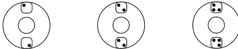
*As caçapas podem ser colocadas ao redor do rotor em qualquer uma das configurações de carregamento do rotor mostradas. Cada caçapa deve ser carregada simetricamente com tubos como mostrado acima.*
