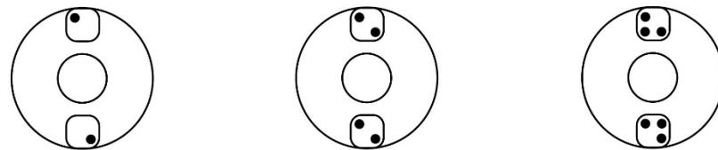
*I cestelli possono essere posizionati attorno al rotore in qualsiasi configurazione di carico del rotore mostrata. Ogni cestello deve essere caricato simmetricamente con le provette come sopra.*
