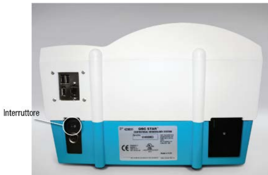
Figura 7 – Interruttore (a sinistra)
