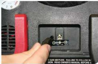
2. Verbinden Sie den Adapterstecker mit dem Stromeingang auf der Rückseite der Stromstation.
