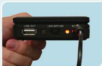
**3.** Stecken Sie das Gleichstromnetzteil in den Anschluss mit der Aufschrift „DC-IN“ (Gleichstromeingang) mit der Solarstromversorgung, um den Lithiumionenakku vollständig zu laden. Ein rotes Licht zeigt einen Ladestatus von <50 %, ein orangefarbenes Licht zeigt einen Ladestatus von >50 % und ein grünes Licht zeigt eine volle Ladung.
