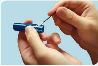
Vermeiden Sie bei der internen Reinigung einen starken Druck auf die Linsen und Filter.
