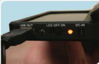
**6.** Stellen Sie den Stromschalter auf „ON“ (Ein). Bei ausreichendem Sonnenlicht blinkt das Anzeigelämpchen rot.
