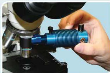
◀ Ziehen Sie die Fingerschraube an, bis die Lichtquelle sicher befestigt ist.
