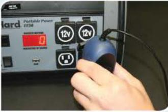
2. Verwenden Sie einen US-Adapter und das Netzteil und verbinden Sie die ParaLens-Lichtquelle mit dem Wechselstromausgang der mobilen Stromversorgung.
