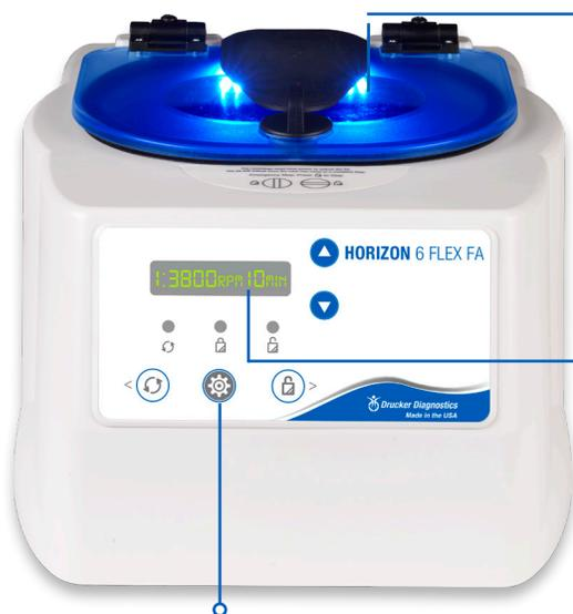
Die Lichter auf dem Deckel zeigen den Status an: bereit, läuft, fertig
