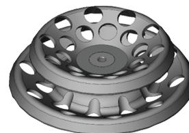
*Su centrifuga debe contener una carga equilibrada para poder funcionar correctamente. Para asegurarse de que la carga esté balanceada, recuerde estas reglas cuando inserte las muestras de los tubos de ensayo en el rotor de ángulo fijo de 20 posiciones:*
